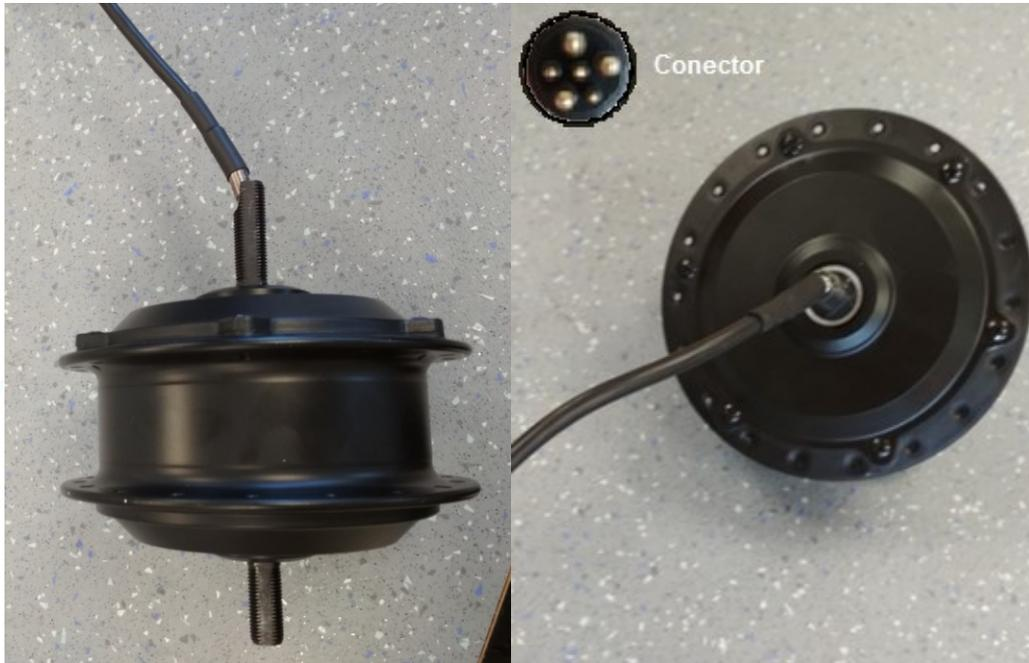
En este tipo de motor la salida de la manguera va en el eje, es propensa a rozarse y se terminan rompiendo algunos cables, este motor puede funcionar aunque de forma defectuosa con algún cable partido, los motores de tercera versión montados en las bicicletas del número 3701 a 5280 también tienen la salida del cable por el eje, pero en este caso el conector tiene nueve pines
