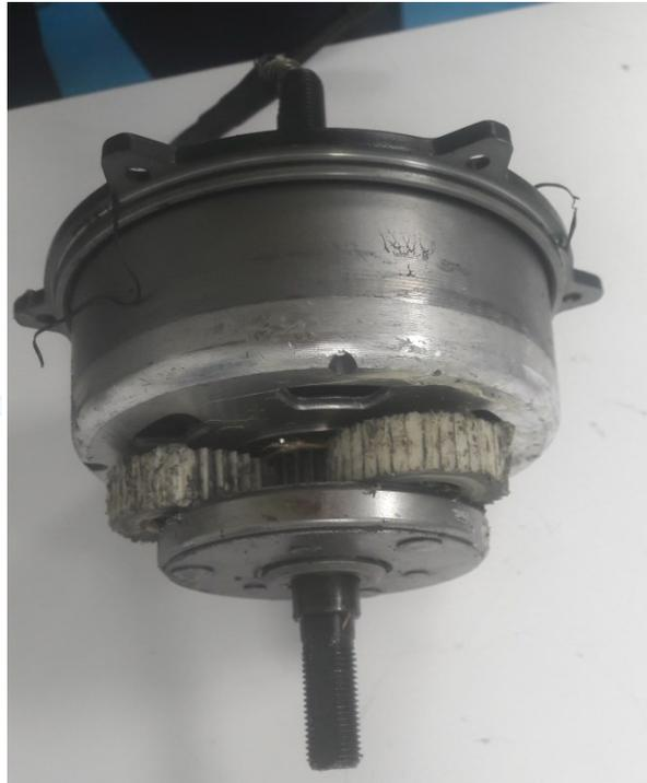
Antes de instalar los nuevos engranajes conviene comprobar la compatibilidad con el engranaje que se va a sustituir dado el alto número de posibilidades existente y el gran parecido entre ellos.
