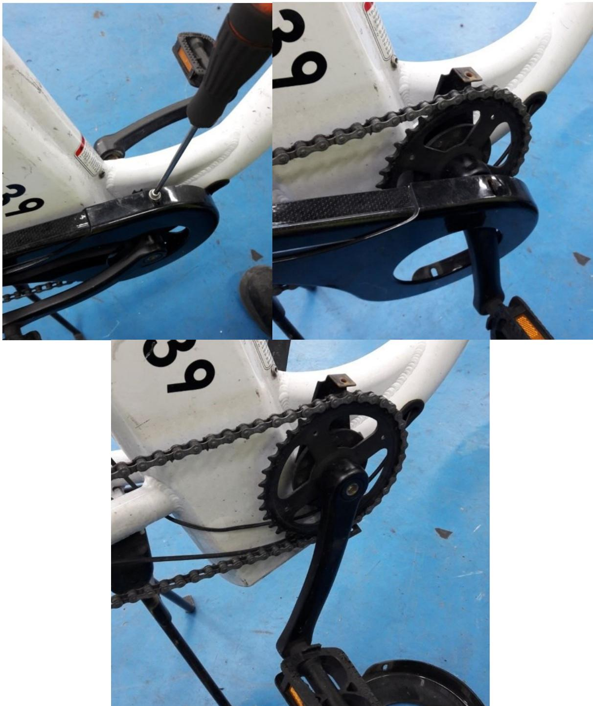
En la primera generación de sensores, el acceso al tornillo de fijación se hace desde el lado del plato y a través de él, como muestra la imagen. Lo aflojaremos mediante un destornillador Phillips PH0 o PH1. Tener cuidado que no se caiga el tornillo pues quedará pegado al imán.
