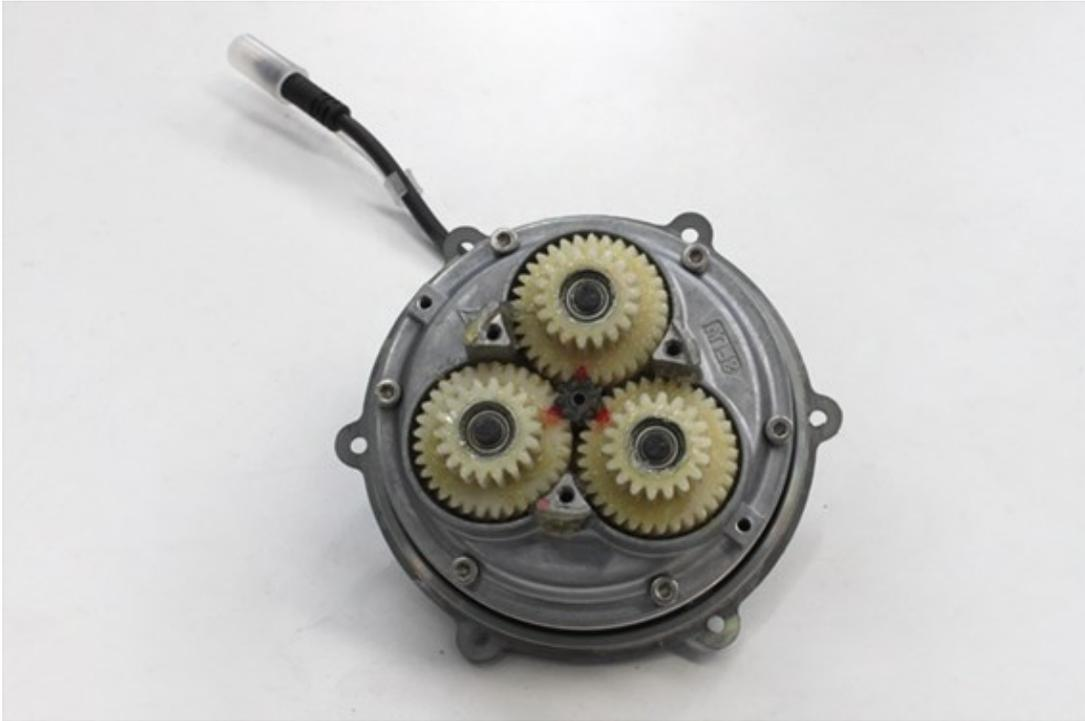
Estos motores van unidos a la llanta mediante 6 tornillos de estrella que lo fijan al buje.
