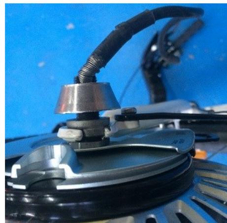
Voltear nuevamente la bici y retirar el adaptador. Ahora, aflojar con una llave allen de 6 la potencia y retirar de la bici. En caso que esta no salga, bastará golpear ligeramente el tornillo para desbloquear el fijador desplazable. En este momento, con la llave de 36, específica para direcciones, se puede aflojar la contratuerca y la tuerca de la dirección y retirar la horquilla dañada.
