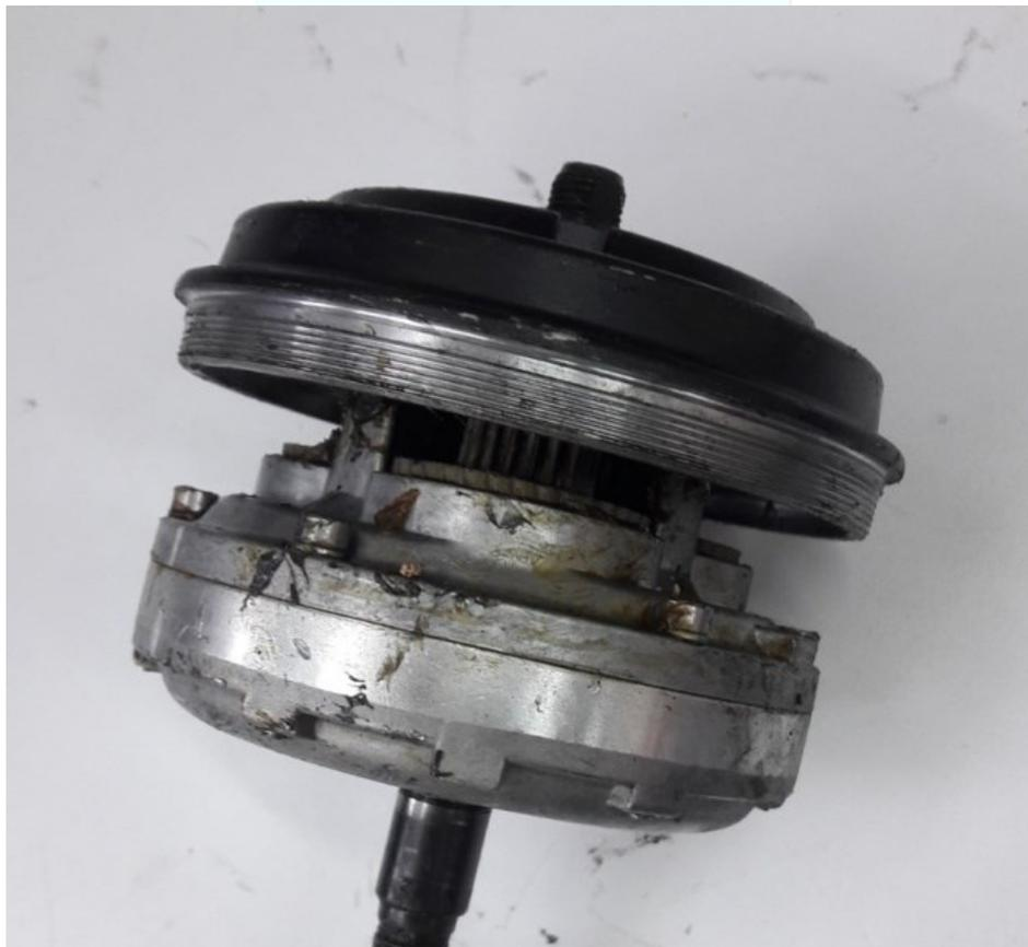
Motor extraído del buje. Se puede apreciar el roscado de la tapa.
