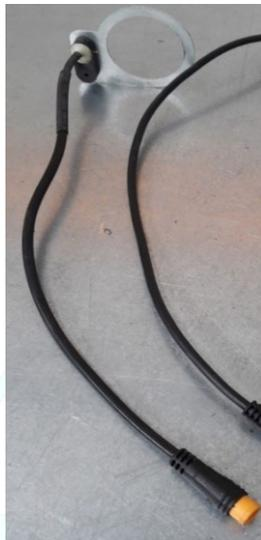
Este tipo de sensor no lleva led de tal forma que hay que comprobarlo manualmente sustituyéndolo por un sensor de test. Este sensor es especialmente delicado a la separación con el disco magnético ya que su alcance es pequeño. En caso de tener que sustituir el sensor hay que prestar especial atención en el guiado del cable evitando curvas forzadas o zonas expuestas a roces
