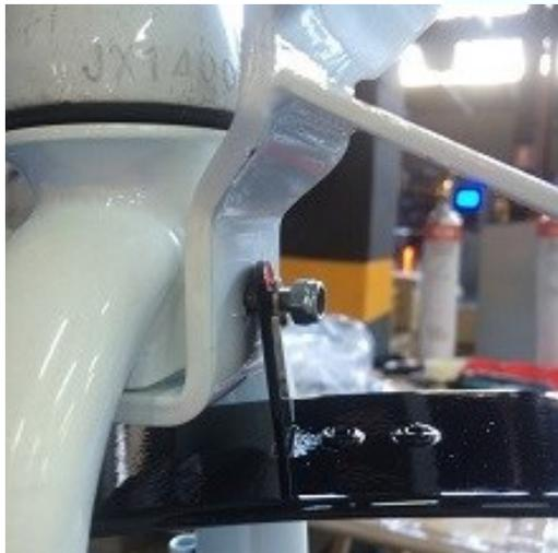
Es importante que la brida de sujeción se monte por la parte frontal del adaptador pues de esta manera se aleja la parte inferior del neumático, además de quedar anclado de manera más sólida.
