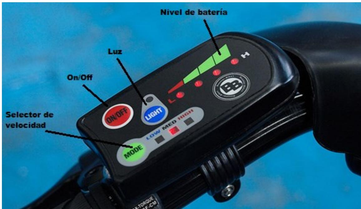
La bicicleta está compuesta por una batería que se encarga de suministrar la energía necesaria para hacer funcionar todo el sistema eléctrico, con el pulsador rojo se enciende el sistema de tracción eléctrica y se muestra el nivel de carga de la batería, con el pulsador verde se selecciona el nivel de ayuda en el pedaleo, siempre hay que comenzar a pedalear con el nivel de ayuda más bajo e ir subiendo progresivamente
