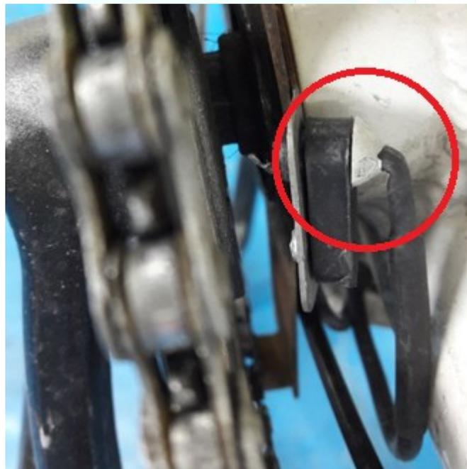
Para sustituirlo hay que desmontar el cubrecadena, de esta forma hay acceso al tornillo de fijación
