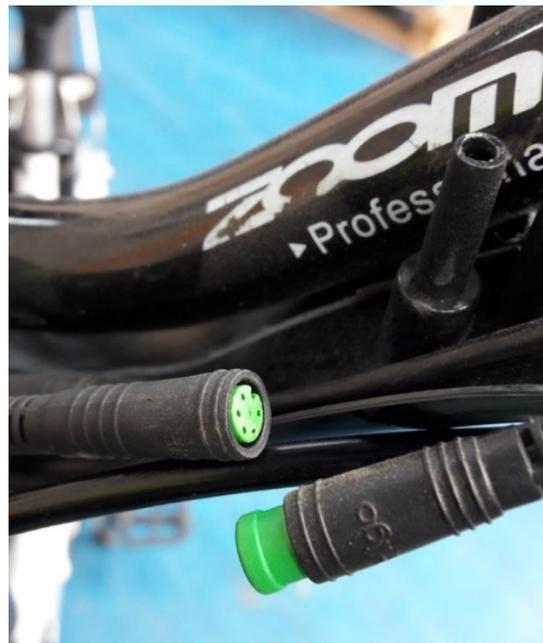
Es muy importante asegurarse que cada display vaya montado con la controladora adecuada, ya que de no hacerlo así se rompe y no vale, esto es debido a que los pines de alimentación del conector tienen la polaridad al revés.
