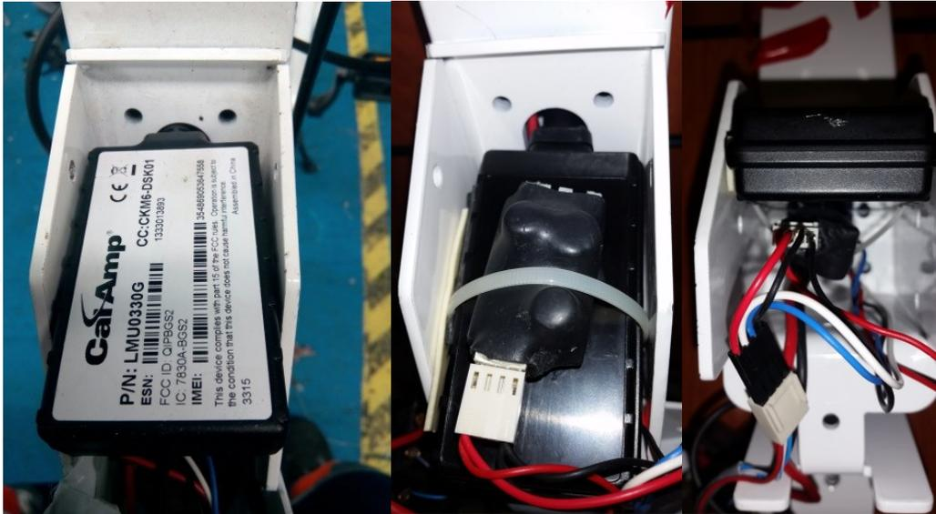
Colocar la tapa de anclaje en su lugar sin llegar a cerrar con los remaches y comprobar la alimentación de los pines, tanto exteriores como interiores para garantizar la buena conexión de los conectores nuevos.
