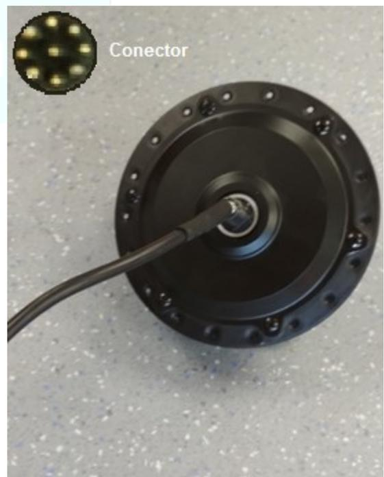
En estos motores el corte de cualquiera de los cables conlleva la parada del motor.
