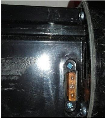
En la batería hay dos fusibles, uno es para la carga de la misma de 10 Amperios y el otro es para la salida de potencia de 30 A, con lo que puede darse el caso de que cargue y no suministre tensión a la salida o viceversa, que de tensión a la salida y no cargue.
