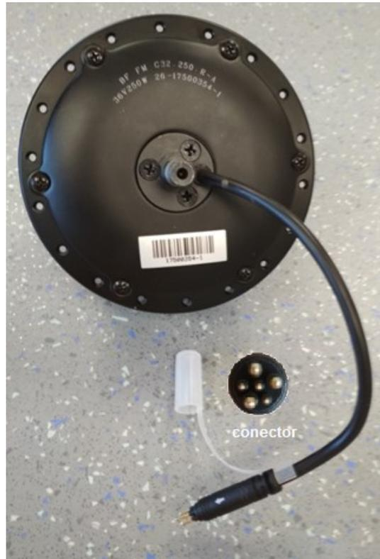
Este tipo de motor va montado en las bicicletas del número 1700 a la 3701, tiene un conector de 6 pines, este motor puede funcionar aunque de forma defectuosa con algún cable partido
