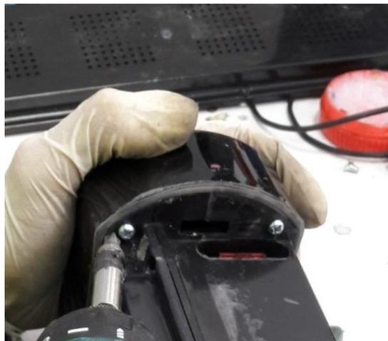
En el interruptor cortacorrientes hay soldados 2 cables de 2mm que vienen de la batería, hay que comprobar que en la posición ACTIVADO sale tensión del interruptor, también se puede medir la continuidad entre los polos del interruptor, pero esta medida no es del todo fiable, ya que puede darse el caso, que el polímetro mida bien la continuidad y al hacer circular gran cantidad del corriente por el interruptor, si este tiene fogueados los contactos la tensión de salida de este se venga abajo
