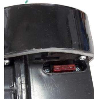
En caso de detectar que el fusible exterior se encuentra en buen estado, hay que comprobar la continuidad del fusible térmico de 84° que va instalado en el interior del paquete de batería. Para ello, hay que abrir la empaquetadura azul de la batería para encontrarlo en el tramo intermedio del cable rojo de 1mm que conecta los 2 paquetes de celdas.
