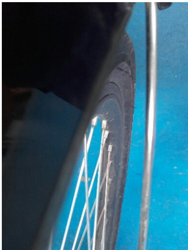
Distancia excesiva entre neumático y guardabarros
