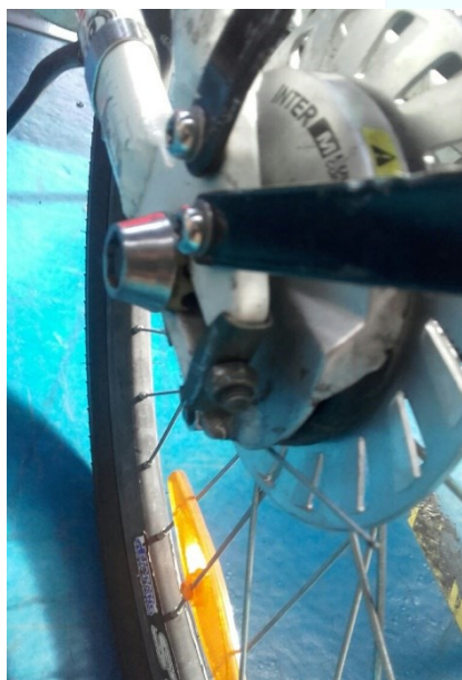
Versión 1ª soldada al cuadro, con tendencia a deformarse.
