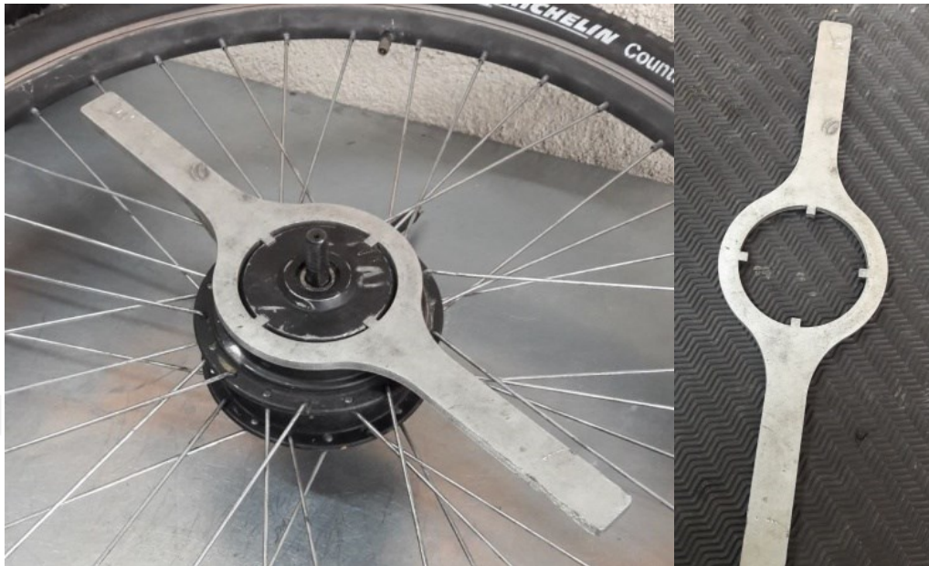
Llave de motor específica para desenroscar la tapa de este tipo de motores
